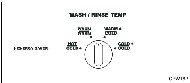
Se dispone de cuatro temperaturas de WASH/RINSE (lavado y aclarado): lavado HOT (caliente) con aclarado COLD (frío), lavado WARM (tibio) con aclarado COLD (frío), lavado WARM (tibio) con aclarado WARM (tibio) y lavado COLD (frío) con aclarado COLD (frío).
